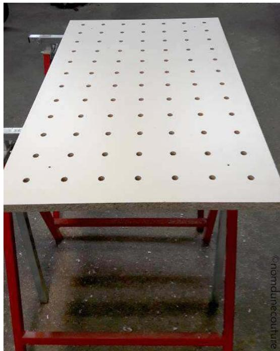
**7. Percez ensuite les 4 trous de fixation** (diamètre correspondant à la future vis de fixation) suivant le même principe que dans le point n°6.
